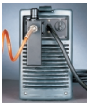
Startschakelaar, manometer, elektrische en persluchtaansluitingen
