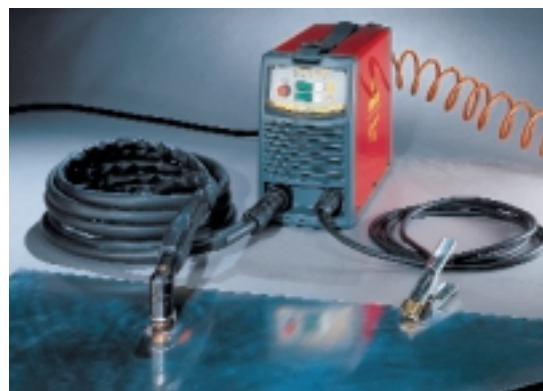
Startschakelaar, manometer, elektrische en persluchtaansluitingen
